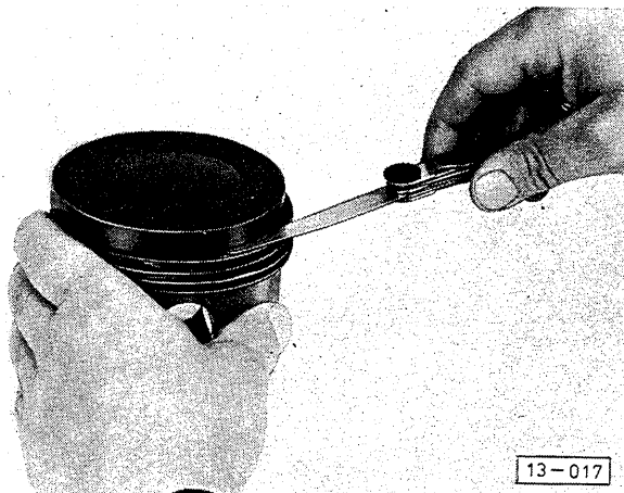
Fig. 4 Segments – Vérification du jeu en hauteur
