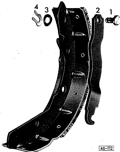
Fig. 9 Fixation correcte du levier de frein avec un pivot neuf
