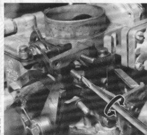
Carbureteur Solex 34 PICT 5 Réglage du ralenti à froid
