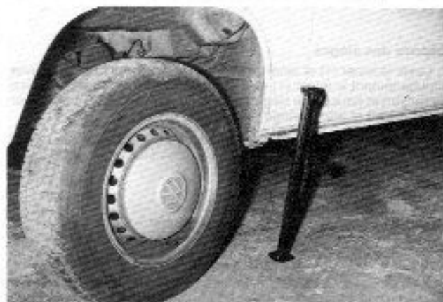
Mise en place du cric (photo RTA).
