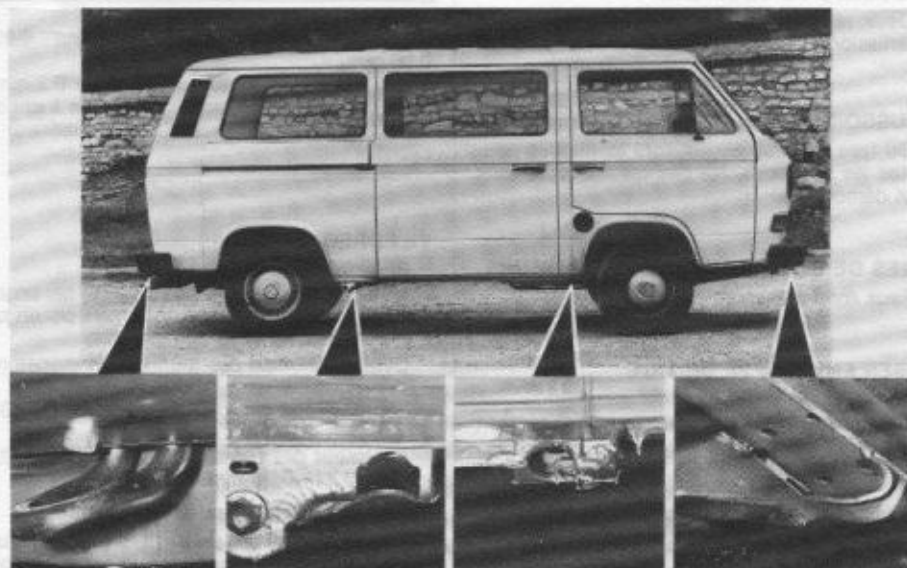
Levage-remorquage : (de droite à gauche) Remorquage avant - Levage avant - Levage arrière - Remorquage arrière
