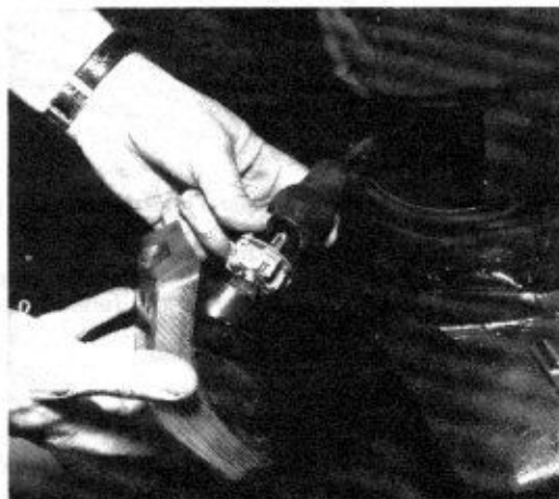
Remplacement d'une lampe de clignotant avant.
