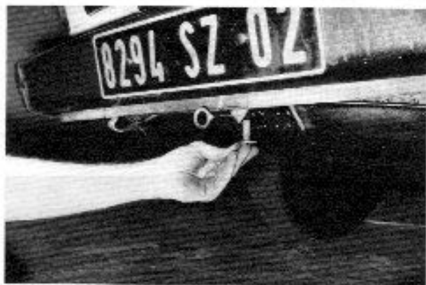
Mise en place du boulon de maintien du berceau de roue de secours (photo RTA).
