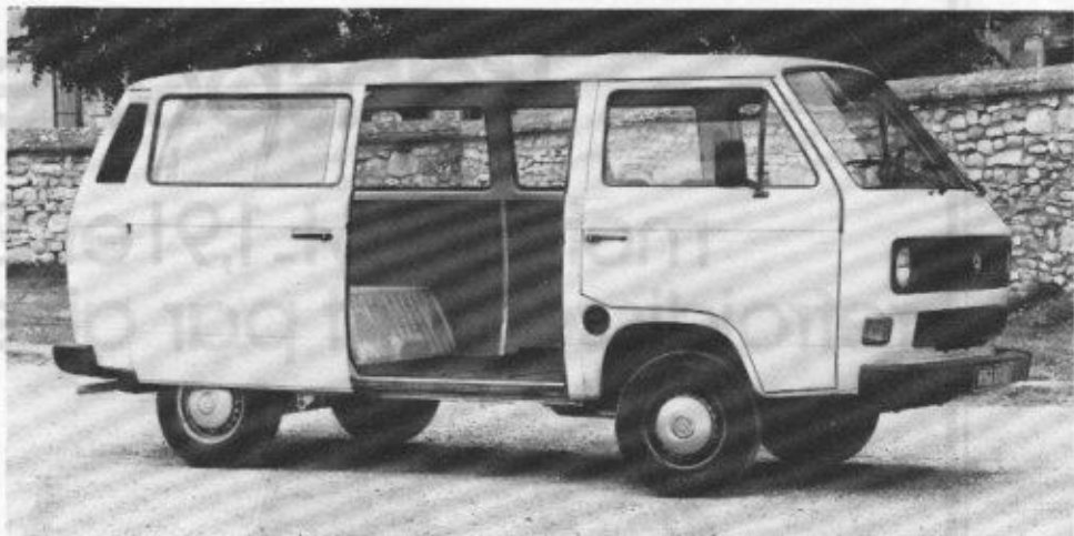
Un Transporter à moteur 1 913 cm 3 à refroidissement par eau. Comme le Diesel il possède un radiateur à l'avant avec une calandre supplémentaire.
