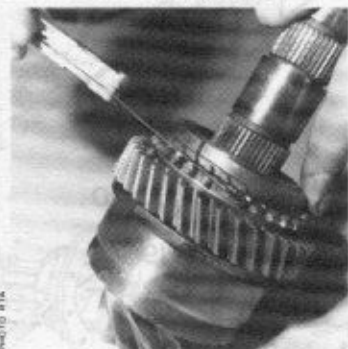
Contrôle de l'usure de la bague de synchro de pignon de 2°
