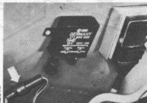
Raccordement des fiches du capteur de stabilisation de ralenti
