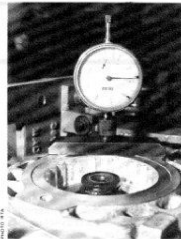
Mesure de l'enfoncement des écrous de différentiel par rapport au carter
