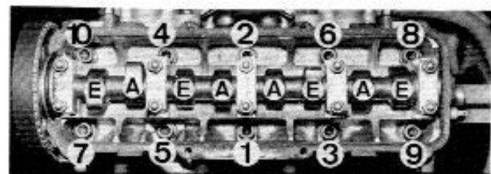
Ordre de serrage de la culasse et disposition des soupapes.
