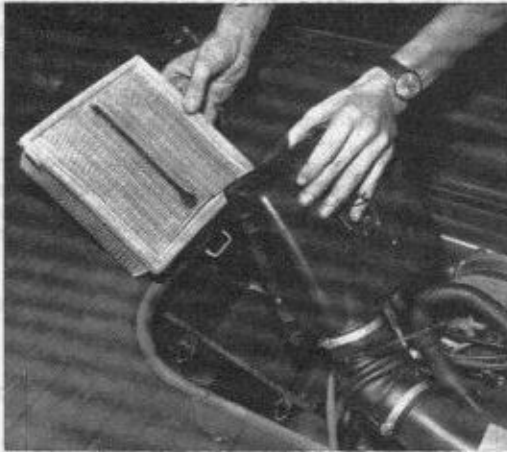
Echange de l'élément filtrant du filtre à air.
