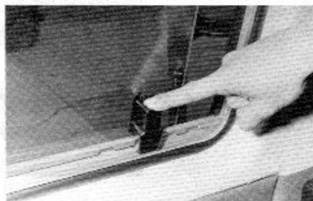
Levier de déblocage des dossiers des sièges centraux (suivant équipement) pour accès à la banquette arrière (photo RTA).
