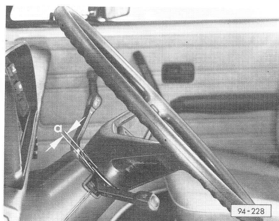
Fig. 6 Vérification de l'écart entre le volant et la commande des clignotants
