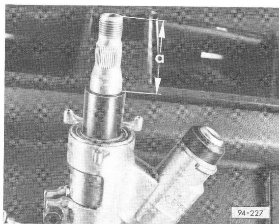
Fig. 5 Réglage de l'écart entre le bord supérieur du manchon du tube de direction et la partie supérieure de la colonne de direction
