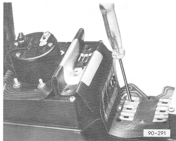
Fig. 9 Repose de l'ampoule dans le boîtier de témoins
