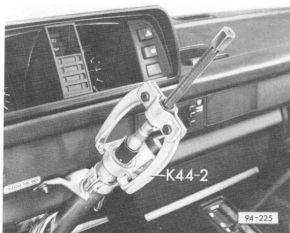
Fig. 3 Dépose de l'antivol de direction
