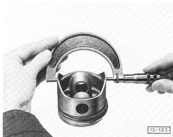
Fig. 11 Ø du piston: vérification
