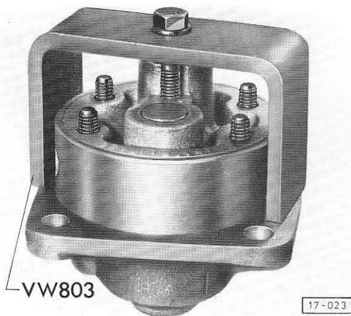
Fig. 2 Couvercle de pompe à huile: extraction
