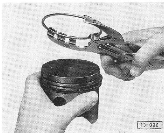
Fig. 5 Segments de piston: dépose et repose
