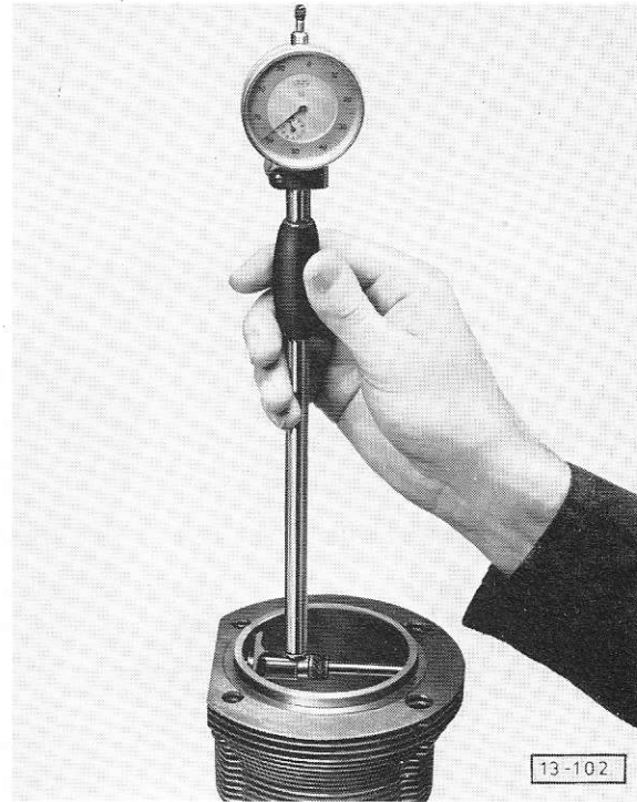
Fig. 10 Alésage du cylindre: vérification
