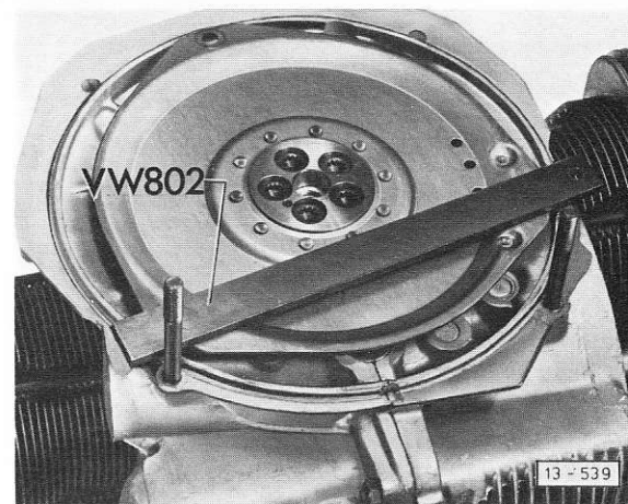
Fig. 11 Disque d'entraînement: dépose
