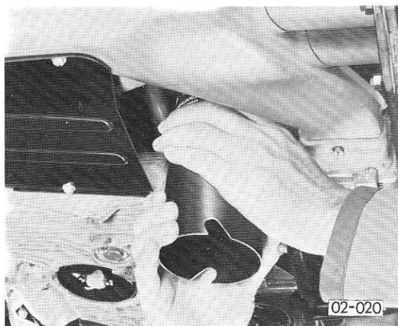
Fig. 3 Filtre à huile: dépose et repose
