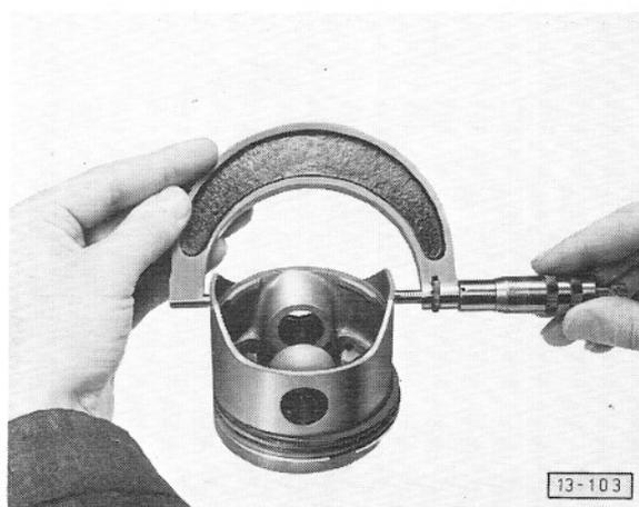
**Fig. 7** Vérification du diamètre du piston
