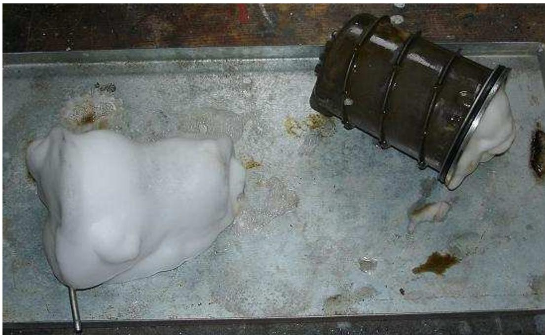
Plusieurs fois, s'appliquent lorsque le brûleur (à gauche) et la chambre de combustion (à droite). En particulier dans le brûleur incrusté Rußanteile se battent très élevé et que chimiquement. Au moins 10 cycles de nettoyage ont été nécessaires pour le (probablement) dernier Rußteile avait quitté le brûleur pendant le rinçage. (Remarque: Dans la dernière
