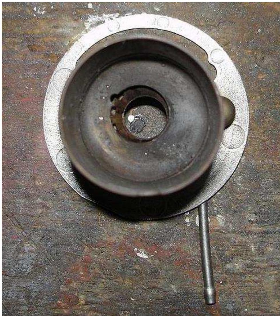
En un peu plus loin le brûleur insérer la nouvelle bague d'étanchéité:
