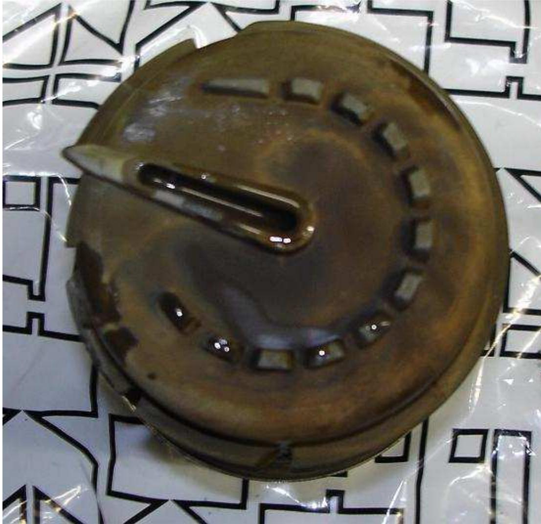
La chambre de combustion est fermée par un fort joint torique contre l'eau de refroidissement. En conséquence, la Chambre est assis "fermement" dans cette affaire. Pry pour le démontage avec tournevis robuste grâce à la conduite d'eau inférieur. Lors de l'installation, sélectionnez la position avant, comme on peut être tourné difficiles dans la chambre de logement et donc la position de la rainure-crête doit être pris exactement comme possible déjà.
