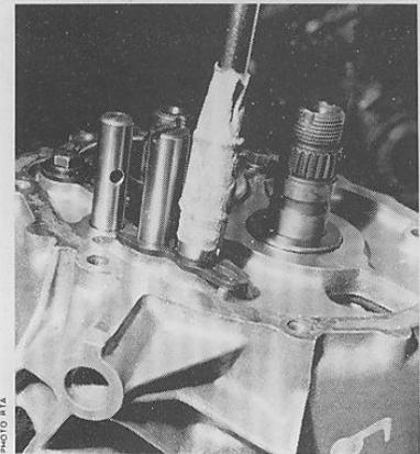
Dépose de l'épingle de maintien de l'axe fixe de 1<sup>er</sup>/2<sup>e</sup> et 3<sup>e</sup>/4<sup>e</sup>.
