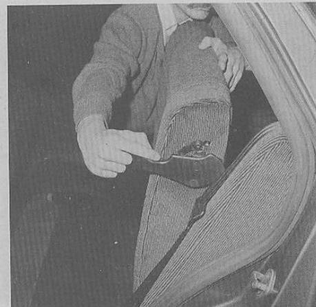
Déverrouillage du ou d'un dossier arrière sur break (Photo RTA).
