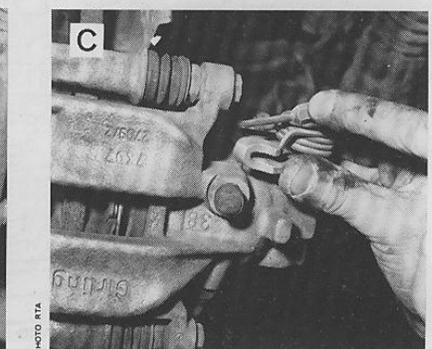
Remplacement des plaquettes de frein arrière
