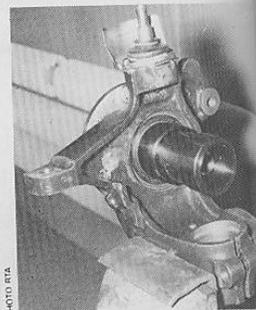
**Repose du moyeu sur le pivot.**
