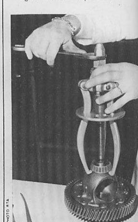
Extraction d'un roulement du boîtier de différentiel.
