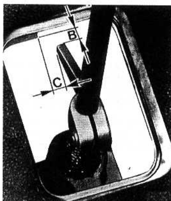
Réglage du positionnement de levier des vitesses (boîte à cinq rapports) B. 3 - C. 3 mm
