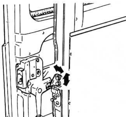
Possibilités de réglages du tenon.
