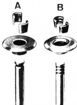
Identification des soupapes. A : ancien montage B : nouveau montage
