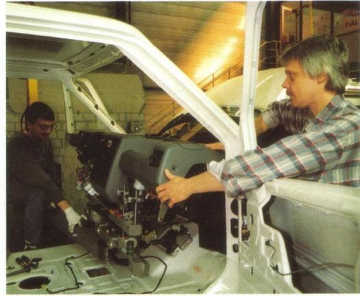
Pose du tableau de bord pré-monté, à l'aide d'un dispositif de montage.
