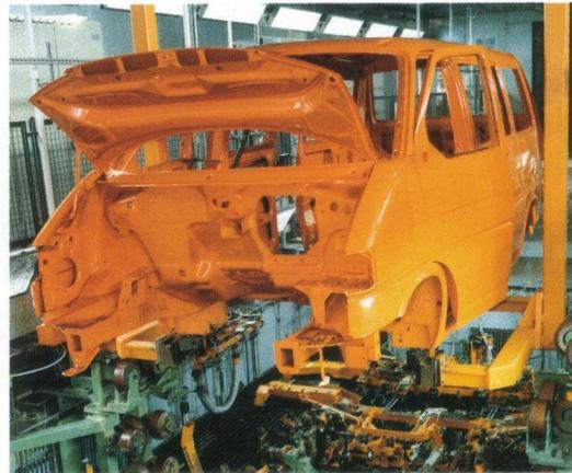
Le système d'injection de cire chaude fonctionne automatiquement.
