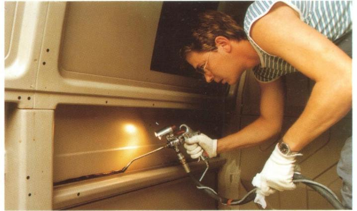
Collage des profils de renforcement sur les parois intérieures.
