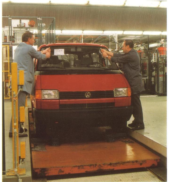
Positionnement et montage du pare-brise.
