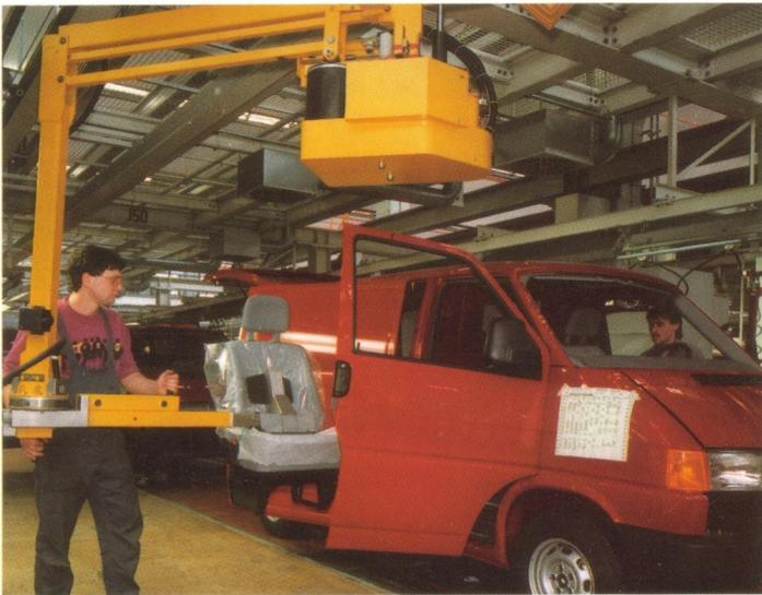
Des dispositifs de levage aident au montage des sièges.
