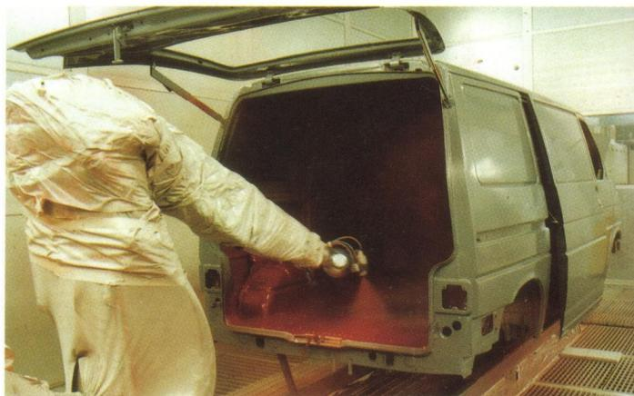
La carrosserie venant de l'assemblage tôlerie est plongée dans un bain chaud de dégraissage avant d'arriver à l'atelier de peinture. Elle traverse ensuite les étapes de fabrication suivantes – en ordre serré: phosphatation au zinc, application cataphorique de la couche de fond par immersion, protection du soubassement et étanchement des joints par des matières synthétiques spécifi-
