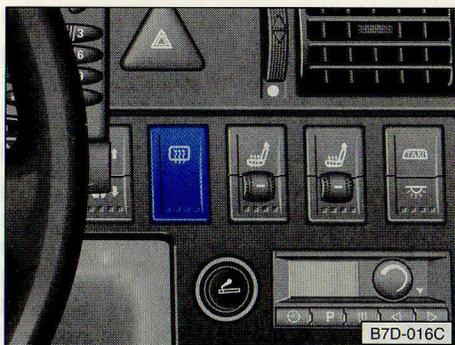
Le dégivrage ne fonctionne que lorsque le contact d'allumage est mis. Lorsque le dégivrage est commuté, un témoin s'allume dans la commande.
