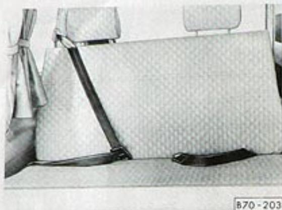
Le véhicule est équipé de ceintures de sécurité différentes sur la banquette/couquette en raison des dispositifs du camping-car: vu dans le sens de marche, il y a du côté droit une ceinture automatique trois points et du gauche une ceinture sous-abdominale à enrouleur automatique.
