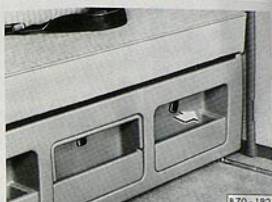
Pendant le réglage, poussez en direction du bloc cuisine le levier (flèche) placé en bas devant la banquette.
