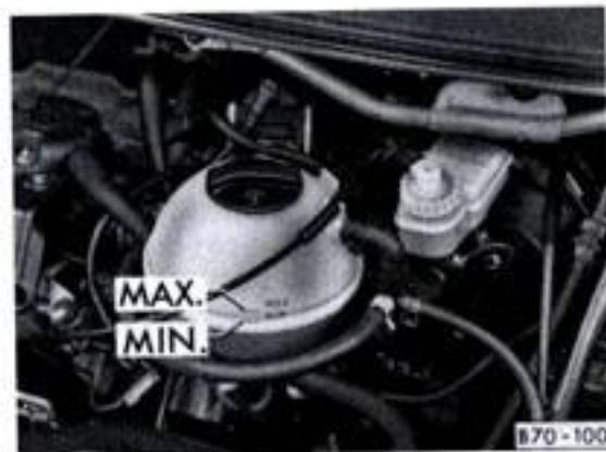
Le niveau du liquide à moteur froid doit être compris entre les repères MIN. et MAX. du vase d'expansion; à moteur chaud, il peut être légèrement au-dessus du repère MAX.
