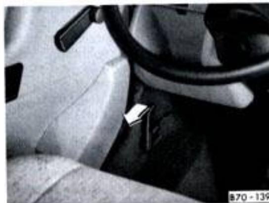
**Pour déverrouiller** le capot, tirez le levier placé à gauche sur le panneau latéral, sous le tableau de bord – le capot-moteur se soulève hors de son verrouillage sous la pression du ressort.
