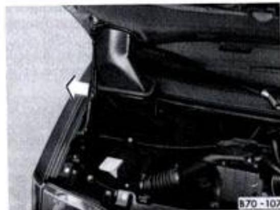
**Pour fermer** le capot-moteur, soulevez-le légèrement et tirez la béquille de capot vers l'avant – voir figure. Laissez tomber le capot d'une hauteur de 30 cm environ dans le dispositif de verrouillage – n'appuyez pas sur le capot.
