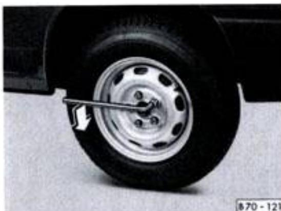
■ Poussez la clé sur le boulon de roue comme représenté jusqu'en butée et faites-lui effectuer une rotation vers la gauche en la tenant le plus près possible de son extrémité.
