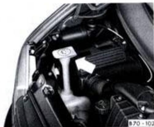
Le réservoir de lave-glace se trouve à droite dans le compartiment-moteur. Il a une capacité d'environ 5 litres, sur les véhicules avec lave-phares \* d'environ 7 litres.
