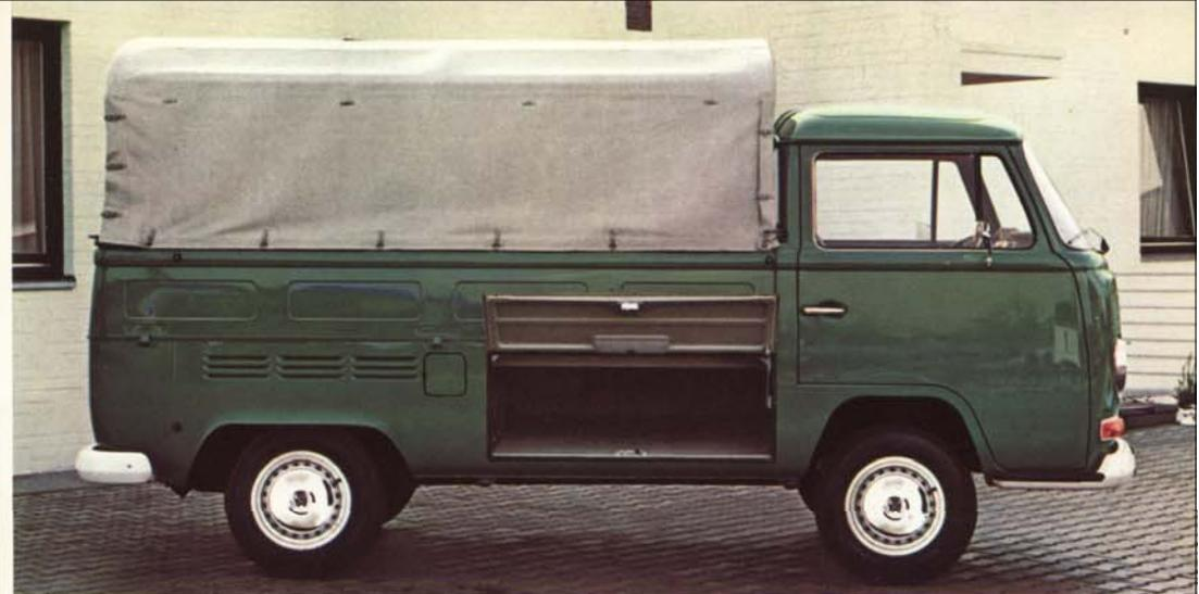
Avec bâche et arceaux (livrés en option), vous disposez d'un volume utile de 4,7 m<sup>3</sup>. Avec la soute (0,7 m<sup>3</sup>) vous obtenez même un volume utile de 5,4 m<sup>3</sup>.
