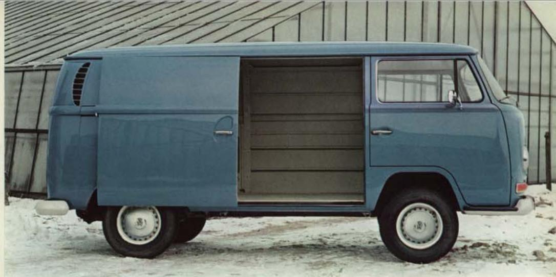
La porte coulissante de la Camionnette VW est livrée de série. Elle mesure 122,5 cm de haut et 106 cm de large. Elle s'ouvre facilement... et reste ouverte, grâce au cran d'arrêt. Le plancher plat est placé bas : à 51 cm du sol.
