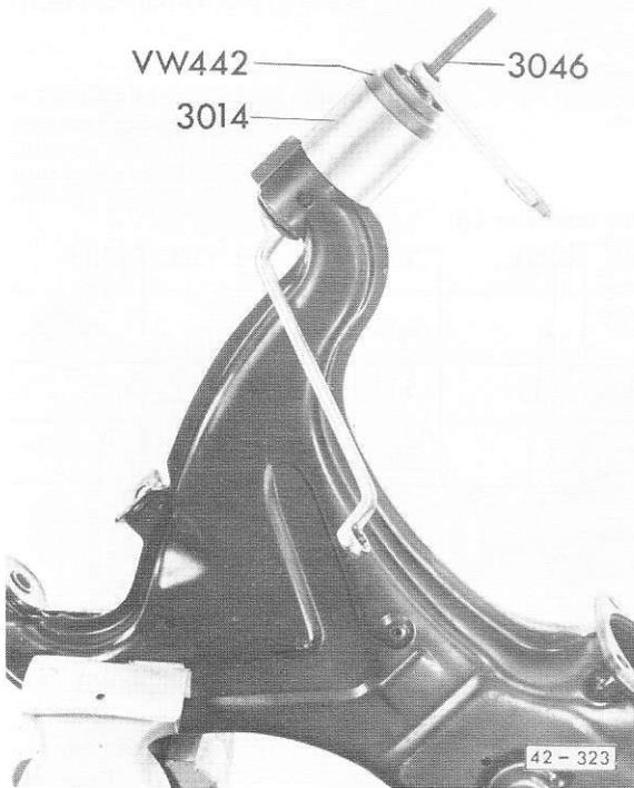
**Fig. 1** Extraction du patin métal-caoutchouc hors du bras de guidage
