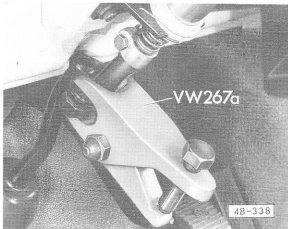
**Fig. 2** Emmanchement de la douille-entretoise: bloquer la colonne de direction en haut et en bas
