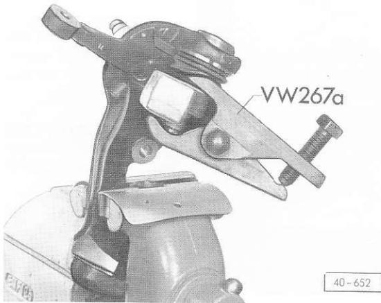
**Fig. 7** Extraction du logement de la rotule inférieure d'essieu
