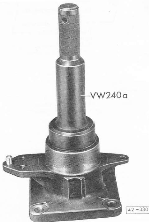
Fig. 4 Emmanchement ou enfoncement des bagues-joints à la presse
