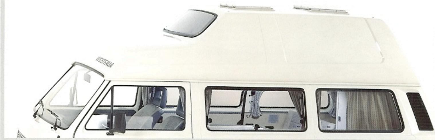
3/5 Grâce au toit télescopique ou au toit surélevé de Westfalia, le fourgon VW peut se transformer en voiture idéale pour le travail et les loisirs. Le client décide s'il veut une hauteur hors-tout de seulement 2,08 m avec une bonne aération pour les pays chauds ou s'il préfère un toit surélevé élégant et mieux isolé pour les froides nuits aux sports d'hiver.
