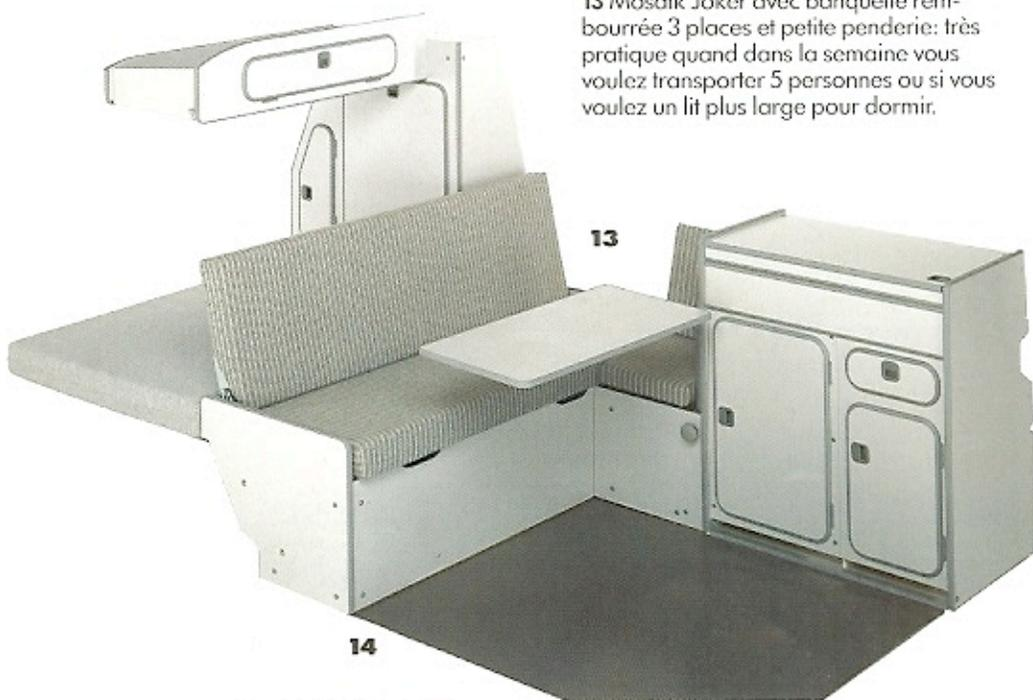
**14** Le plancher de Westfalia est le garant de votre sécurité: des matériaux testés et les points de fixation prévus garantissent un bon ancrage de tous les éléments.
