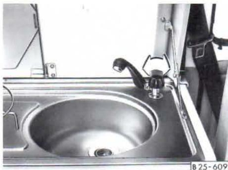
Durch Drehen des Knopfes am Wasserhahn läuft eine Wasserpumpe an, die Wasser in das Spülbecken befördert.
