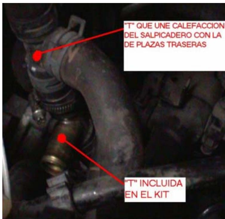
Photo 16 :T de réunion du chauffage et T du kit de montage
